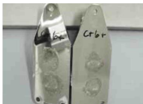
Сильная коррозия с обычным шестивалентным хромом
