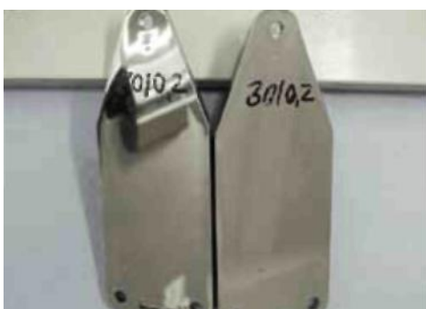
Новое испытание с раствором \text{CaCl}_2 , 336 часов при 60 °C – успех с TriChrome® Plus и TriSeal® IN
