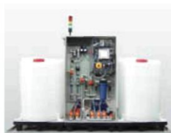
Ионообменная установка для контроля металлических примесей
