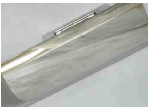
До 48 часов воздействия при испытании CASS с TriChrome® Plus и TriSeal® II
